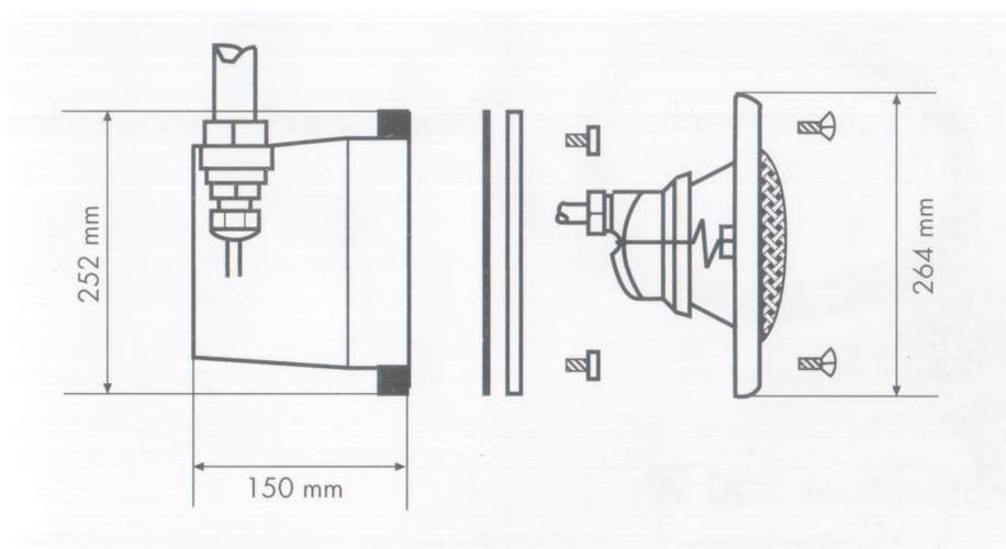
Der NEPTUN Unterwasserscheinwerfer 100/300 W gewährleistet durch den Einsatz von hochwertigem ABS in Verbindung mit speziell gefertigten Edelstahlbuchsen eine lange Lebensdauer.
