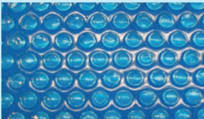
Die eingeschweißten Luftkammern der Iso-Plane vermindern die Wärmeverluste des Schwimmbadwassers. UV-stabilisierte PE-Folie mit Luftkammern in Farbe blau. Die Lieferung erfolgt in rechteckiger Form und lässt sich mit einer Schere einfach auf die richtige Beckengröße zuschneiden. (Lieferung mit 50 cm Zugabe in der Länge). Folienstärke 400 µ. Zum Schutz der aufgerollten Iso-Plane sollte stets die Schutzfolie verwendet werden.
