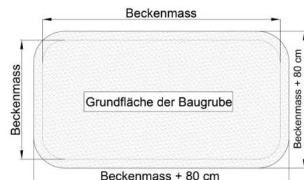
Wir empfehlen die Betonierung einer Bodenplatte mit Stahlarmierung und ca. 15 – 20 cm Stärke (je nach Bodenverhältnissen). Bitte sprechen Sie diesbezüglich mit einem Baufachmann. Bodenplatte über die gesamte Länge und Breite der Baugrube erstellen, so dass Sie die Stützmauern auf der Bodenplatte errichten können.
