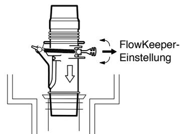
Es regelt den Durchfluss, um sicherzustellen, dass die Filterpumpe und das Reinigungsgerät normal funktionieren. Es wird werkseitig voreingestellt, um die Leistung des Reinigers zu optimieren, bietet aber drei unterschiedliche Einstellungen zum Regeln des Durchflusses.
