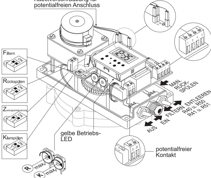
Die BADUTRONIC 93 besitzt einen Ein-/Aus-Schalter (rote Kappe). Mit diesem Schalter kann die Stromversorgung ein- und ausgeschaltet werden. Ein zweiter Kipp-Schalter (grüne Kappe) dient zur Umschaltung von "Filtern" auf "Entleeren". Die Grundposition ist "Filtern", nur bei Bedarf ist der Kipp-Schalter auf "Entleeren" zu stellen, der Entleervorgang muss von Hand abgebrochen werden, da sonst die Pumpe trocken läuft und eventuell zerstört wird.
